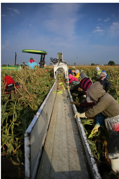
写真3 スイートコーン収穫用農業機械 (サラマンカ市エル・フエルテ社圃場、2017年7月21日、筆者撮影)
