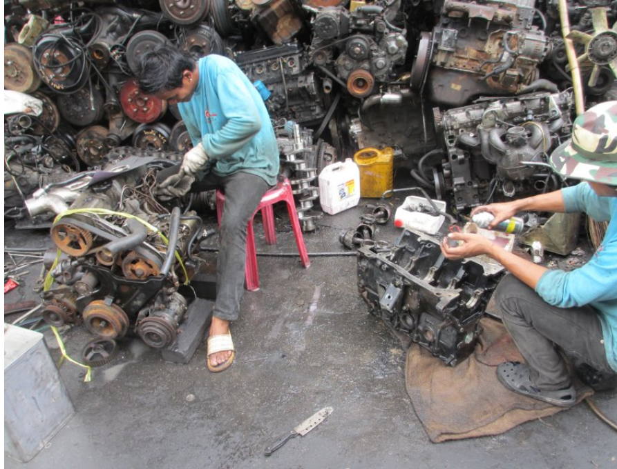
写真2 エンジンの分解作業中
