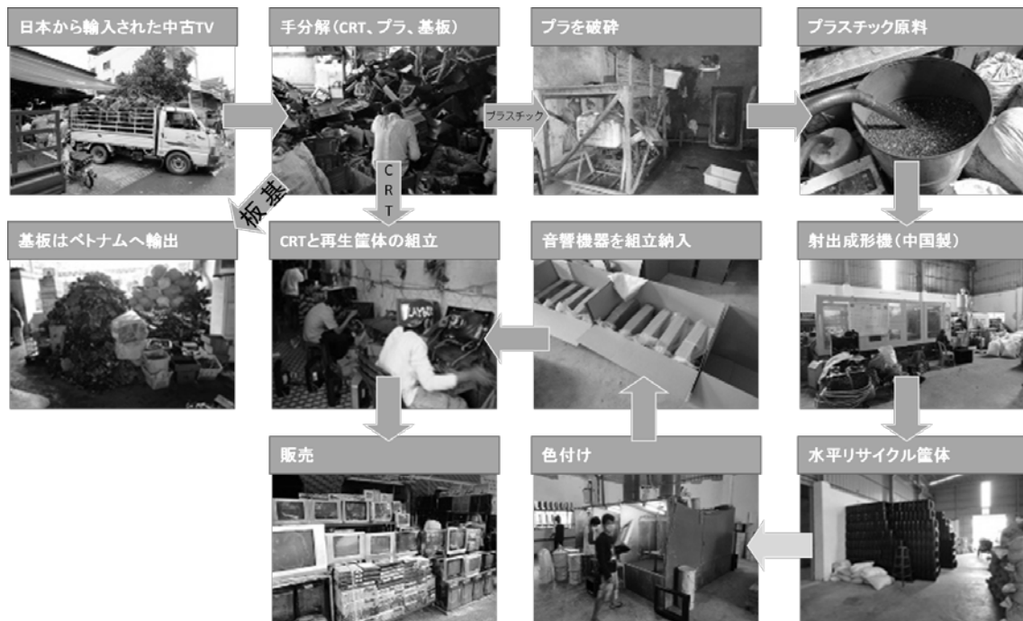
図1 再製造された中古ブラウン管テレビの製造工程
