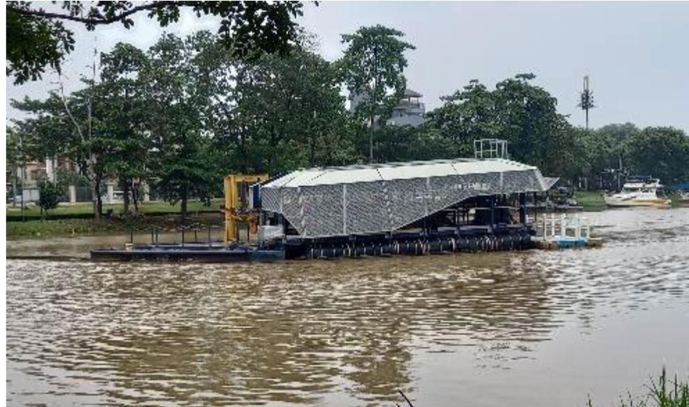
インドネシア・ジャカルタの川に設置されているInterceptor Ocean Cleanupが製造。ブーム（オイルフェンス）を設置し、水面のごみをInterceptorに流れ込むようにしている。2022年11月報告者撮影。
