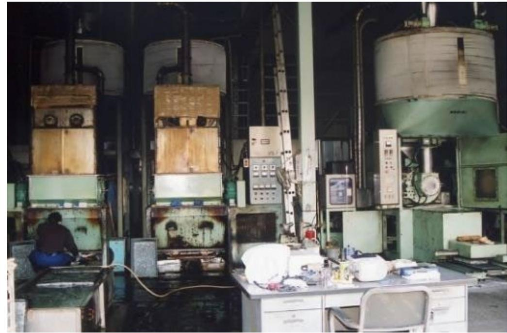
↑ 築地市場に設置されていた発泡スチロールを減容する機械。→ 減容された発泡スチロール
