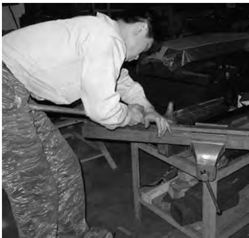
台湾工作機械メーカーでの「きさげ」作業。(撮影：梶谷懐)
